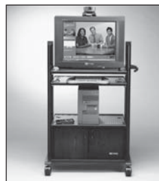
Cameră digitală de luat vederi (sus) Imaginea numerică se prelucrează cu ajutorul calculatorului și se afișează pe ecran
